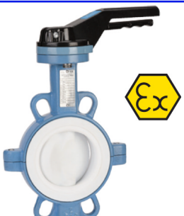
fig 215TT wafer type PN10/16 ansi 150 lbs huis nodulair gietijzer + epoxy coating vlinder RVS316 + TEFLON / as RVS316 dichting PTFE op silicone liner DN32 - DN300 temp. : -25°C/+200°C voorzien van iso 5211 topflens wormwielkast op aanvraag verwisselbare dichting
