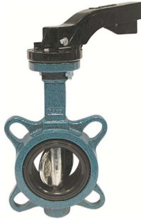
fig 210T wafer type PN10/16 ansi 150 lbs huis gietijzer + epoxy coating vlinder en as RVS316 dichting EPDM DN32 - DN1000 temp. : -20°C/+120°C voorzien van iso 5211 topflens wormwielkast vanaf DN300 ge vulcaniseerde dichting
