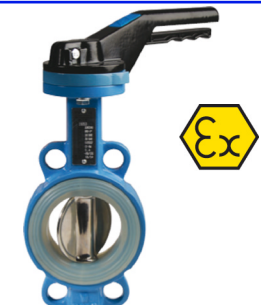
fig 215S FP wafer type PN10/16 ansi 150 lbs huis nodulair gietijzer + epoxy coating vlinder RVS316 gepolierd / as RVS316 dichting voedingsgeschikte SILICONE DN32 - DN300 temp. : -30°C/+150°C voorzien van iso 5211 topflens wormwielkast op aanvraag verwisselbare dichting
