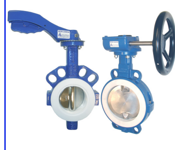
fig 229 wafer type PN10/16 ansi 150 lbs huis GGG40 vlinder en as RVS316 dichting PTFE op EPDM basising DN50 - DN200 temp. : -25°C/+180°C voorzien van iso 5211 topflens wormwielkast vanaf DN150 inbouw lengte volgens DIN 3202 K1
