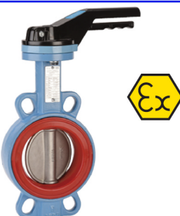
fig 215S wafer type PN10/16 ansi 150 lbs huis nodulair gietijzer + epoxy coating vlinder en as RVS316 dichting SILICONE DN32 - DN300 temp. : -30°C/+150°C voorzien van iso 5211 topflens wormwielkast op aanvraag verwisselbare dichting
