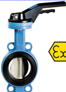
fig 215B wafer type PN10/16 ansi 150 lbs huis nodulair gietijzer + epoxy coating vlinder en as RVS316 dichting NBR DN32 - DN500 temp. : -20°C/+90°C voorzien van iso 5211 topflens wormwielkast op aanvraag verwisselbare dichting
